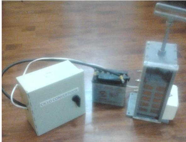
Figura 47. Generador acoplado con ciclo convertidor y banco de baterías
