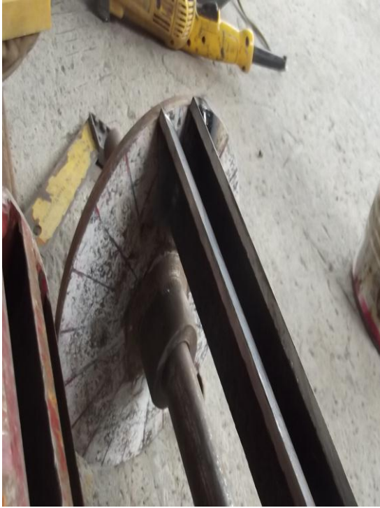
Montaje de los álabes
