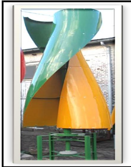
Figura 14. Detalle de Aerogenerador Savonius helicoidal.
