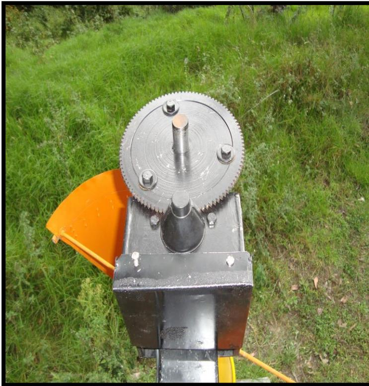
Sistema de transmisión de Aerogenerador de eje vertical con rotor tripala
