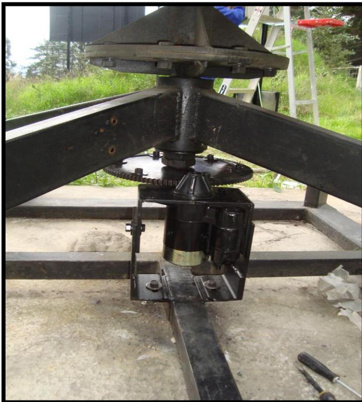
Montaje de sistema de transmisión para los dos aerogeneradores.
