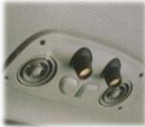
Imagen 4 Lámparas de lectura y ductos de aire
