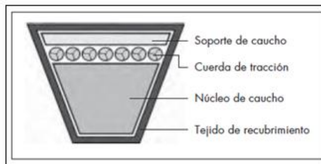
Fig. 12 Estructura de una banda en V
