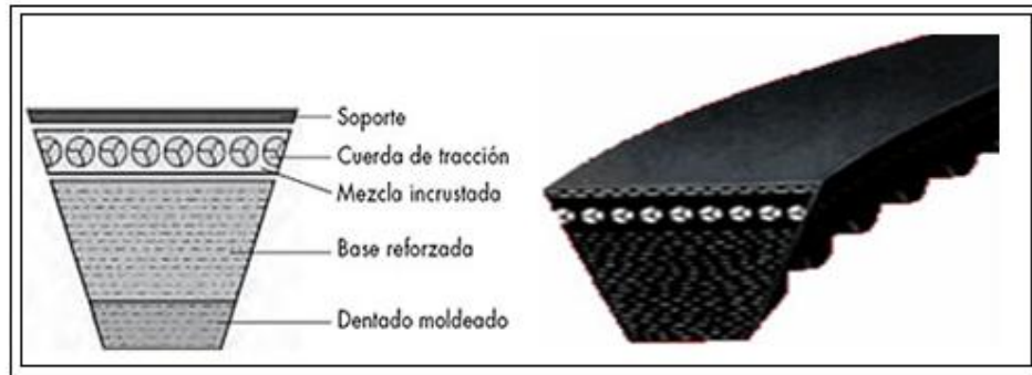
Fig. 15 Composición y forma de una banda trapecoidal o en V corrugada.
