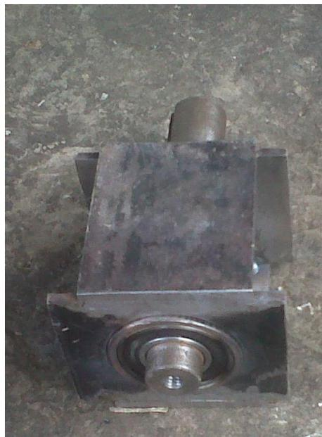
**Vista frontal del acople para el rodillo de aplaste**
