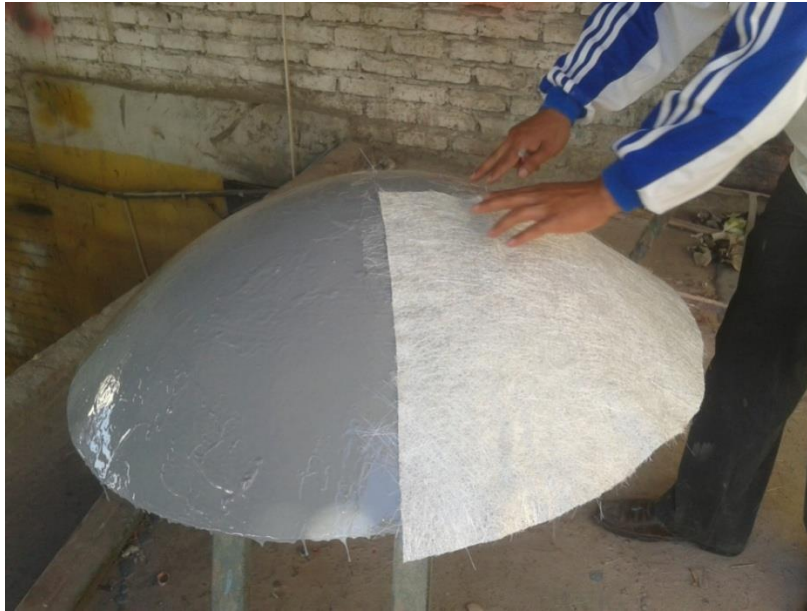
Gráfica 20 Manera de cómo se aplicó la fibra de vidrio
