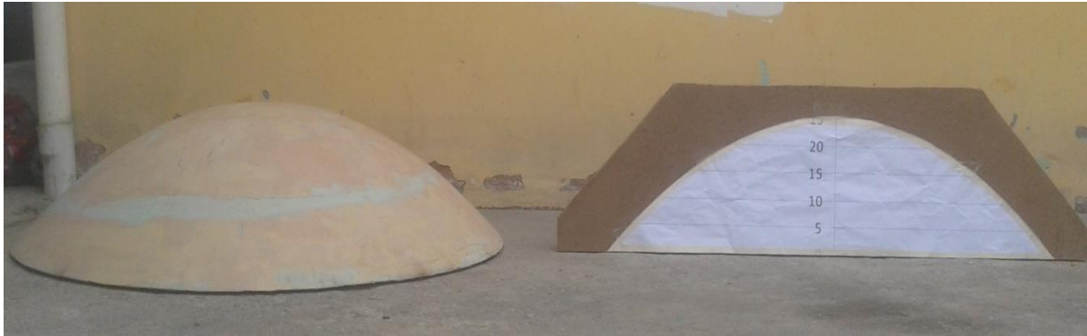
Gráfica 28 Imagen de cómo se trazó la curva de la parábola para verificación de la matriz
