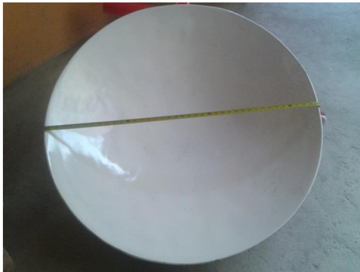
Gráfica 23 Imagen del paraboloide pintado, lista para aplicar el cromado
