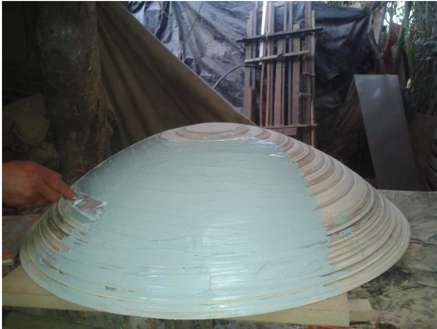
Gráfica 17 Recubrimiento de la matriz con masilla automotriz
