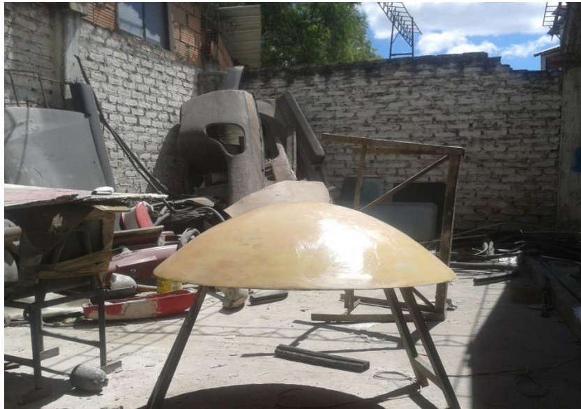
Gráfica 19 Imagen de la matriz lista para aplicar la fibra de vidrio
