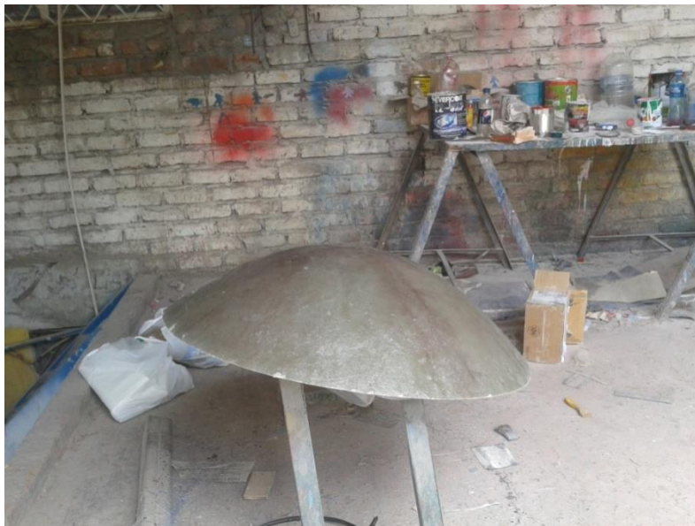
Gráfica 21 Imagen de la parábola recubierta de fibra de vidrio
