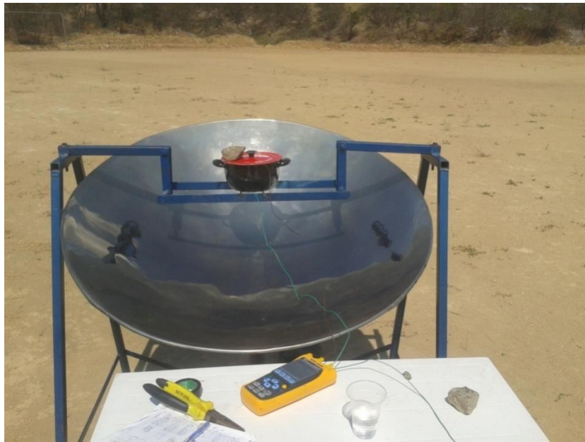
Gráfica 24 Imagen de la cocina solar una vez aplicado el cromado
