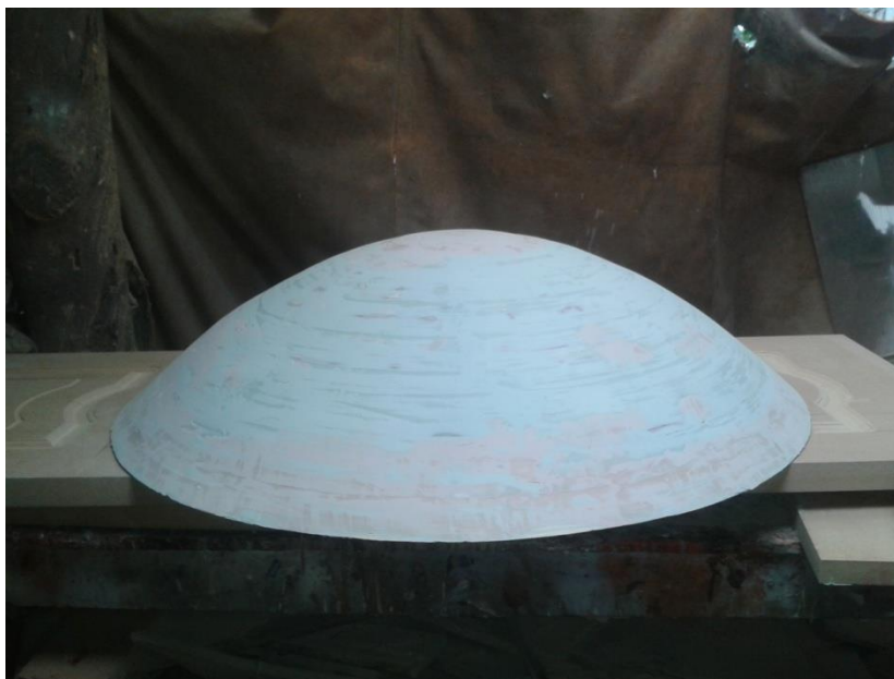
Gráfica 18 Imagen de la matriz una vez pulida la masilla con lijadora
