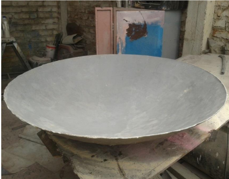
Gráfica 22 Imagen del paraboloide una vez retirada de la matriz
