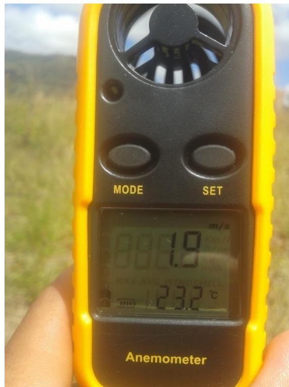
Gráfica 33 Muestra de la velocidad del viento tomado por el anemómetro
