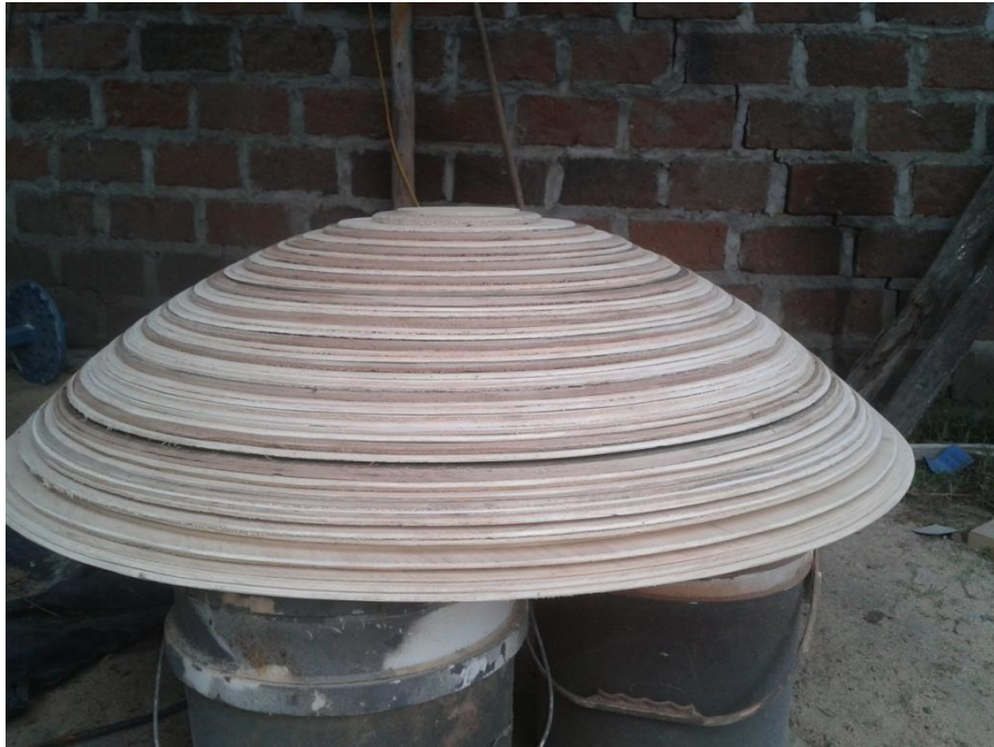
Gráfica 16 Imagen de la matriz armada con plywood
