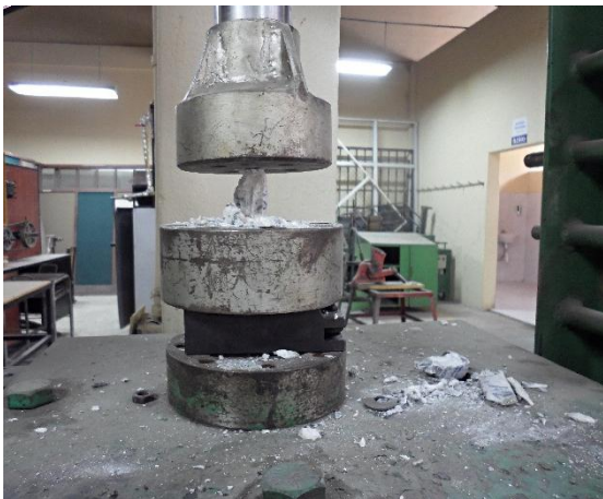
Probetas sometidas a compresión en máquina de ensayos a compresión
