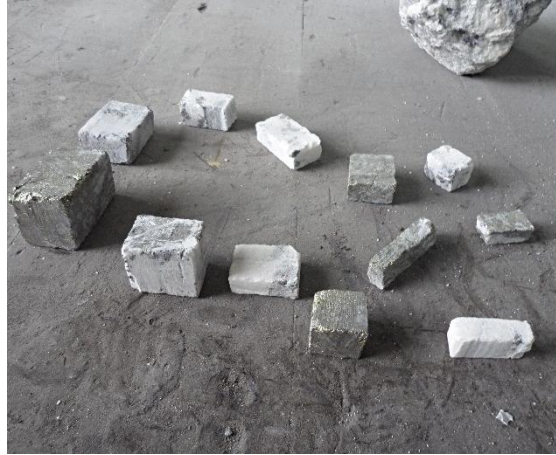
Obtención de probetas a partir de piedras
