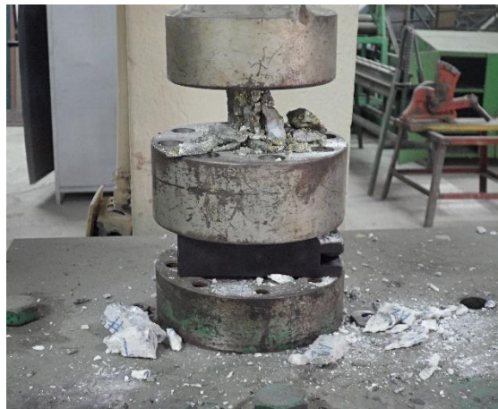
Probetas sometidas a compresión en máquina de ensayos a compresión
