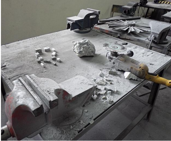
Obtención de probetas a partir de piedras
