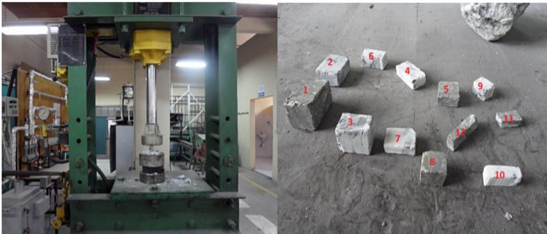
Ilustración 16. Máquina de ensayos a compresión y probetas
