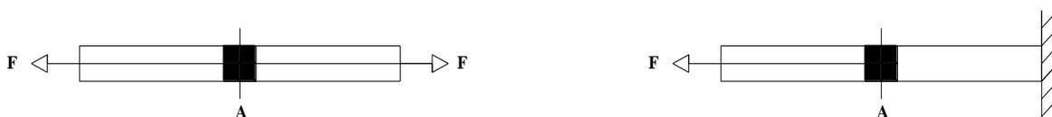
Figura 7. Barra sometida a tracción
