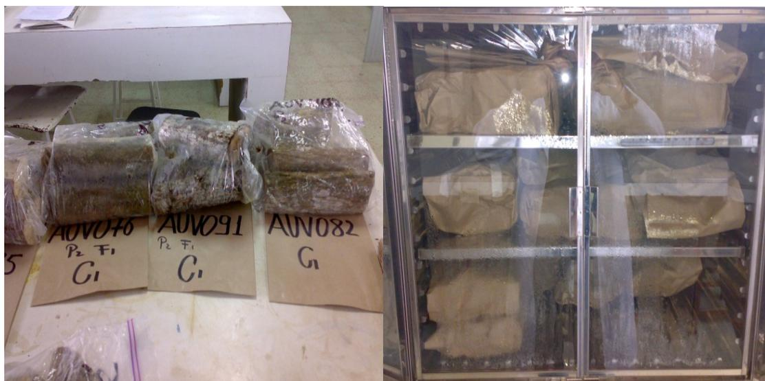
**Figura 12.** Colocación de las muestras de ramas gruesas, finas y hojas, en la estufa a una temperatura de 75-90°C
