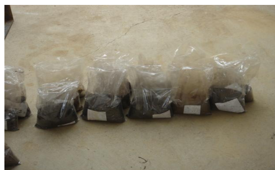
Tamizaje de suelo (tamiz 0,25 mm) que fueron usadas para la determinación de los contenidos de materia y carbono orgánico en cada muestra.
