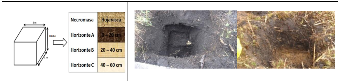
Figura 6. Dimensiones de una calicata instalada a tres profundidades (0-20, 20-40, 40-60 cm) utilizadas para la obtención de muestras de suelo y posterior cuantificación de carbono en los páramos del PNY.
