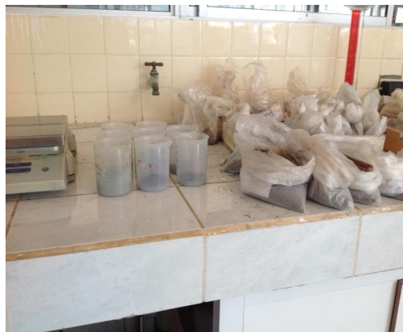
Pesado de 50gr de suelo necesario para determinar la clase textural de cada muestra.
