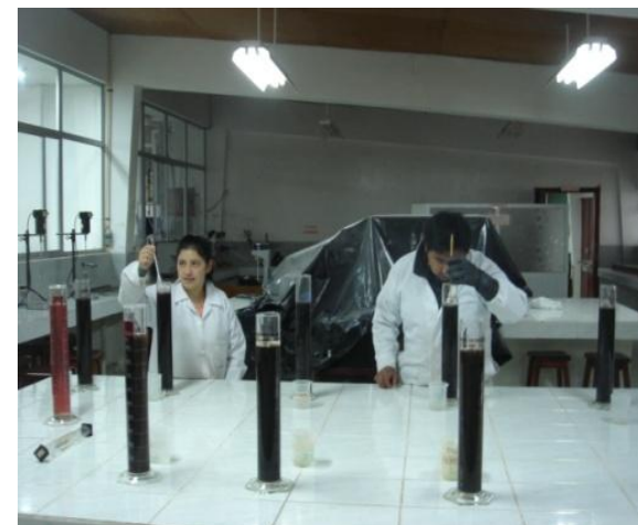
Lectura de temperatura y valor en Hidrómetro, para la determinación de clases texturales de muestras.
