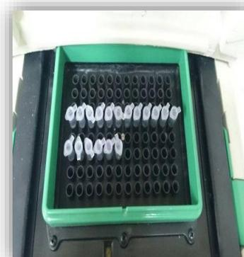
**Foto 4.** Programación de ciclos en el Termociclador y colocación de muestras.
