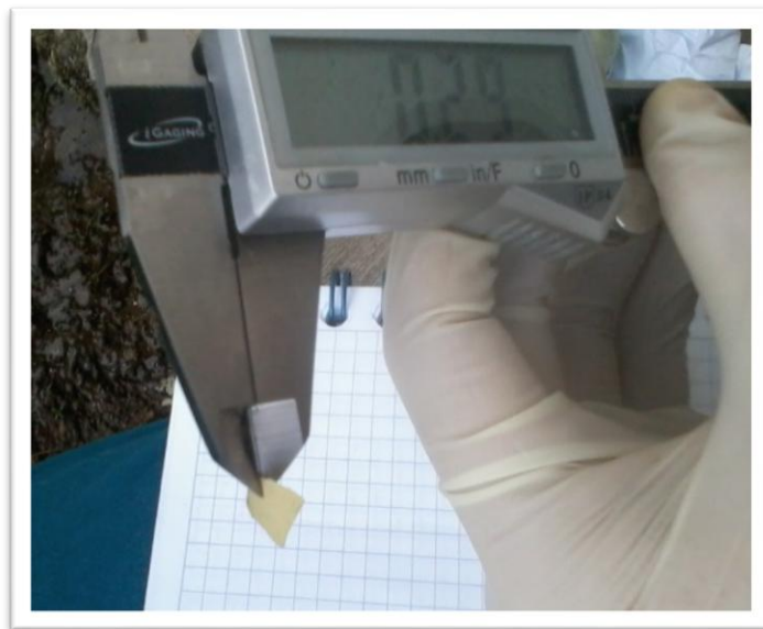
Figura 19. Medición del grosor de la cáscara
