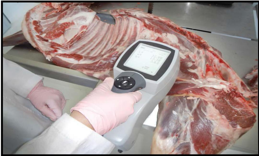
**Figura 3:** Colorímetro (permite medir el color de la carne).
