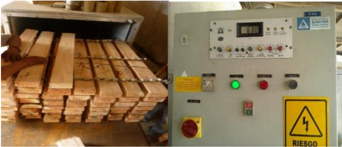
Figura 2. Secado de la madera al 17 % de Contenido de Humedad
