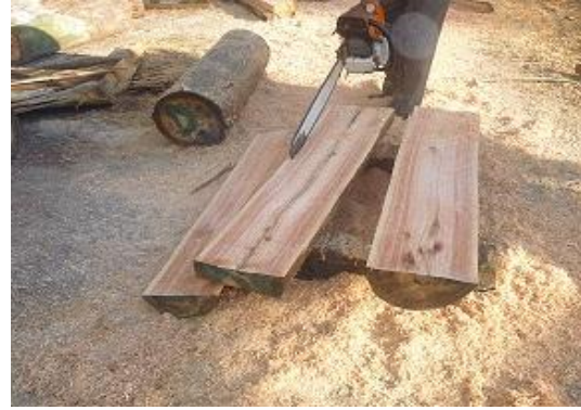
Foto 2. Elaboración de probetas
