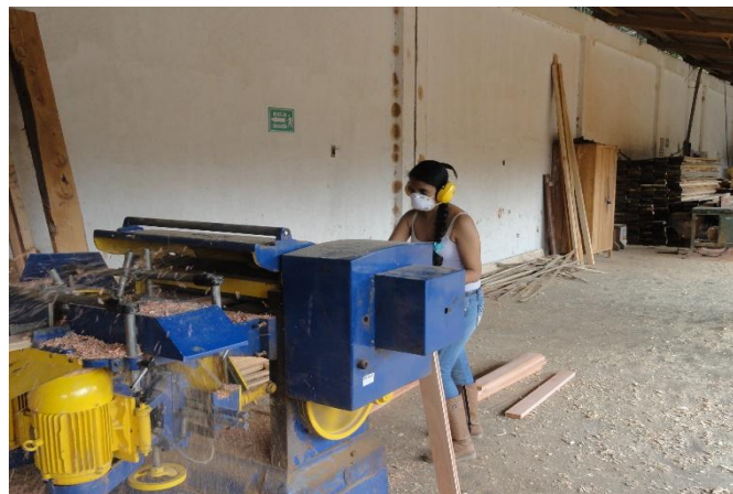
Figura 10. Ensayo de moldurado de la especie Eucalyptus saligna
