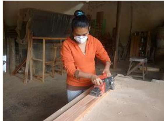
Foto 2. Proceso de lijado
