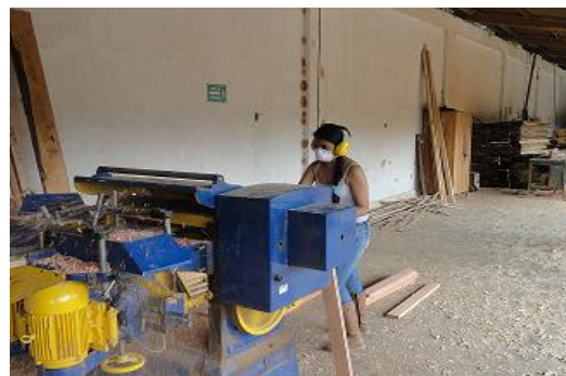
Foto 2. Proceso de moldurado
