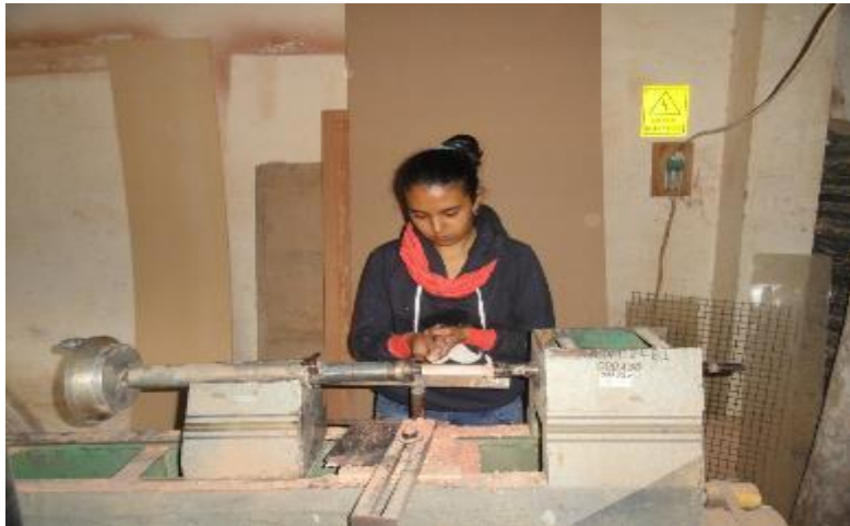
Figura 12. Ensayo de torneado de la especie Eucalyptus saligna
