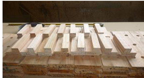
Foto 2. Probetas para el ensayo de moldurado
