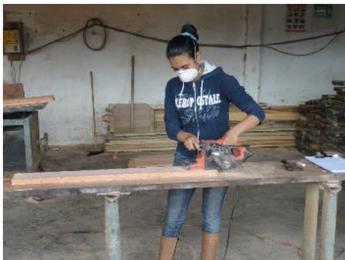
Figura 6. Ensayo de lijado de la especie Eucalyptus saligna
