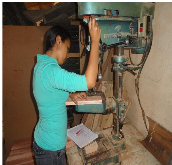
Figura 8. Ensayo de taladrado de la especie Eucalyptus saligna
