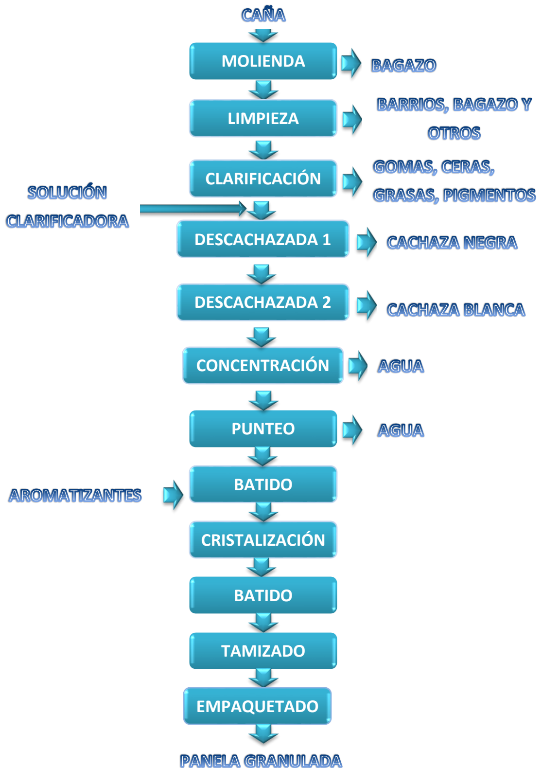
Figura 19. Diagrama de flujo de la fabricación de panela granulada.
