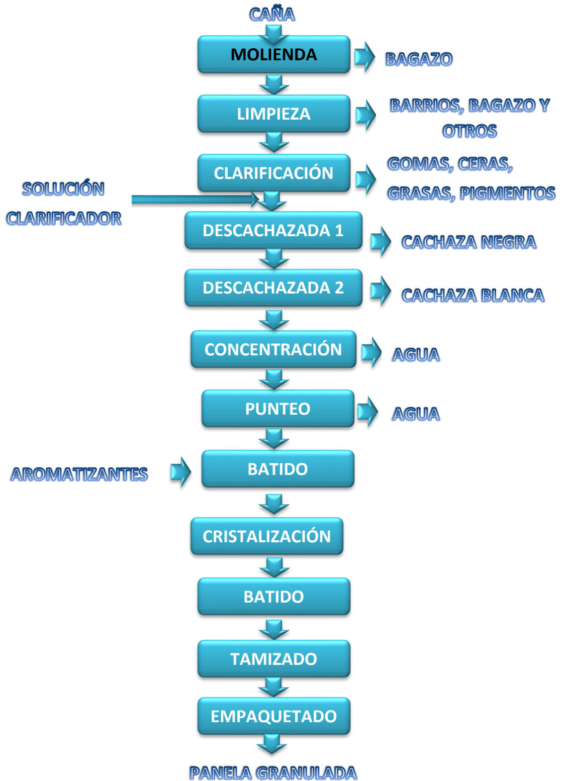
Grafico 1. Diagrama de proceso para la producción de panela granulada Elaboración: El Autor
