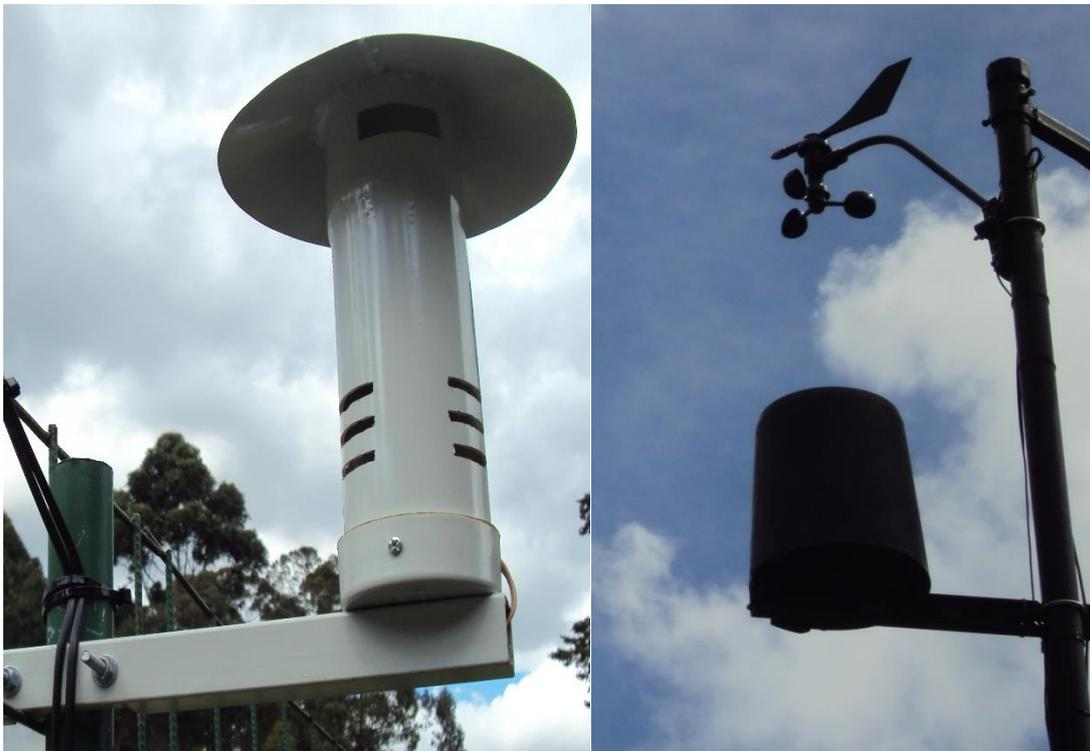
**Figura 64:** Gráfica de los sensores: DHT22, anemómetro, veleta y pluviómetro.
