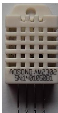
**Figura 18:** Sensor DHT22. Fuente: (El Autor).
