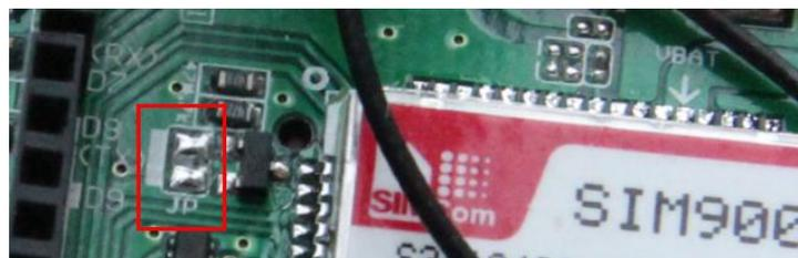
**Figura 16:** Conexión de hardware para modo encendido por Software. Fuente: (18)
