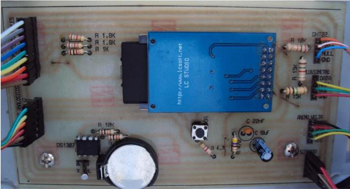
*Figura 65: Gráfica del datalogger y la adecuación para los sensores. Fuente: (El Autor).*
