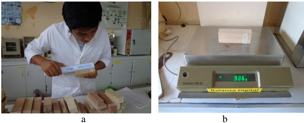
Figura 4. Calculo de la densidad de las Maderas, Volumen (a), Peso (b)
