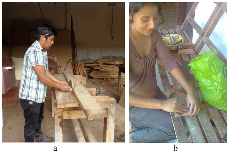
Figura 3. Obtención de probetas. Ligado en máquina (a) y pulido a mano (b)
