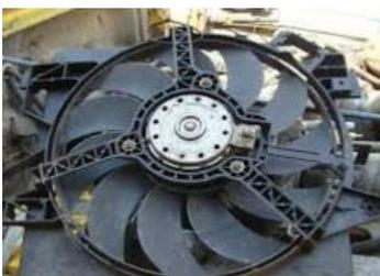
El ventilador del radiador tiene un trabajo importante en el compartimiento del motor. Avienta aire hacia el centro del radiador o lo succiona. Debe enfriar el anticongelante que circula por el bloque y los pasajes principales, así como reducir la temperatura del motor.
