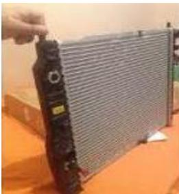
Se conoce por radiador al dispositivo que permite intercambiar calor entre dos medios, siendo uno de ellos, el aire ambiente. Sirve para disipar calor de un objeto o aparato para evitar su sobrecalentamiento o para aprovecharlo, calentando un espacio o un objeto
