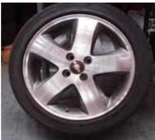
Es la pieza, normalmente metálica, sobre la que se asienta un neumático y que forma parte de la rueda, compuesta esta última por neumático, llanta y disco. La llanta de vehículo turismo propiamente dicha, está sujeta al disco. La función de la llanta es sostener el neumático, y la función del disco es conectar la rueda al vehículo
