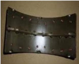
Zapatatas, se utilizan en sistemas de freno de tambor están montadas de dos en dos en el interior del tambor de freno deben detener el movimiento giratorio del tambor de freno.
