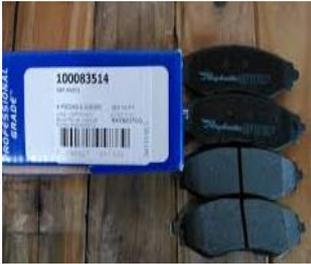
**Las pastillas de freno**, Son aquellos aparatos que nos permiten frenar o parar el vehículo. Esto se realiza a través del ejercicio de presión en ambos lados del rotor de freno, el que gira junto con las ruedas.
