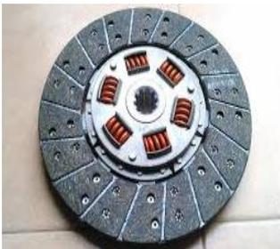
El disco de embrague es el elemento de conexión central del embrague. Junto con el plato de presión del embrague, el disco se ocupa de la unión y separación de motor y de la cadena cinemática.
