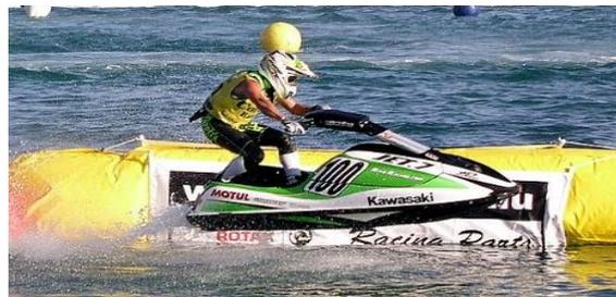
La moto acuática es una embarcación ligera con un sistema de conducción similar al de una motocicleta convencional, con un motor situado dentro de la misma, no usan hélice sino que son propulsadas por un chorro de agua (turbina) esta sale de la parte
