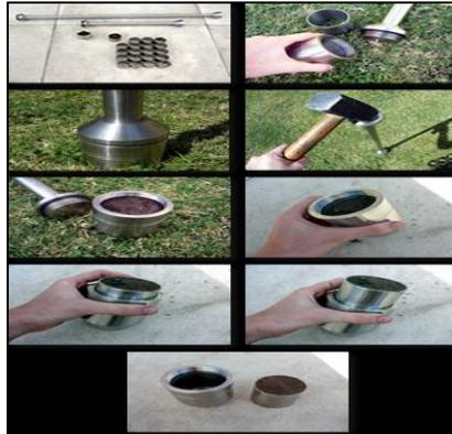
La forma y característica del cilindro tiene por objeto evitar la alteración estructural al tomar la muestra. Luego se sacó el barreno suavemente con el fin de no dañar las muestras. Al sacar el cilindro que estaba dentro del barreno, se eliminó el exceso de suelo con la ayuda de un cuchillo de tal manera que el cilindro quedó totalmente lleno y con esto se poder obtener los 100 cc de suelo
