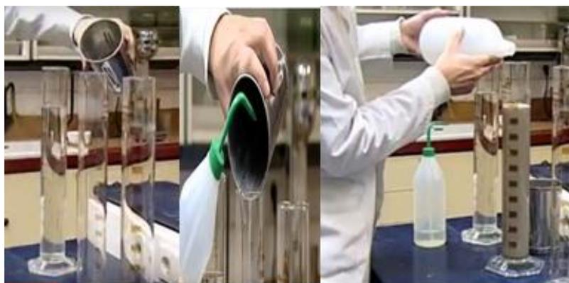
Se colocó nuevamente el hidrómetro en la probeta, para medir la primera lectura al final de los 40 segundos y se anotó en el cuadro de resultados, luego se retiró lentamente el hidrómetro y se midió la temperatura en la suspensión, se anotó en el cuadro de resultados. Después de transcurrido 2H00 de sedimentación se
