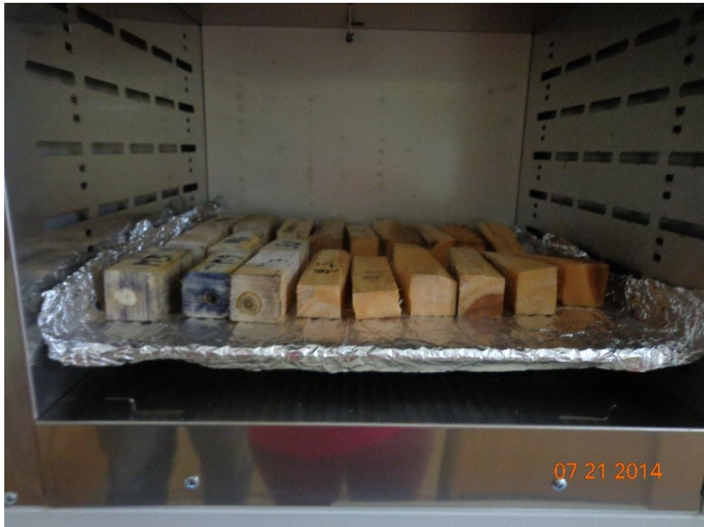
Secado de muestras a 103°C.
