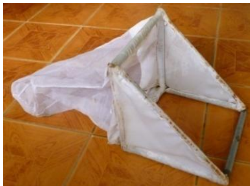
Figura 8. Red surber para la captura de macroinvertebrados.
