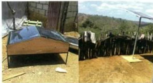
El promedio de agua destilada en 22 días es de 42,78 litros entre los dos destiladores de caseta, así como el destilador de botellas plásticas, suficiente para abastecer de agua a las baterías de los sistemas fotovoltaicos que utilizan en los domicilios del sector que aún no cuentan con energía eléctrica de la red. El agua destilada es para el mantenimiento de las baterías
