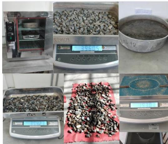
**Figura 44.** Análisis de las densidades del agregado grueso
