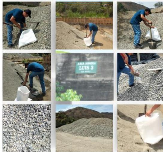
*Figura 33. Recolección de muestras de agregados*
