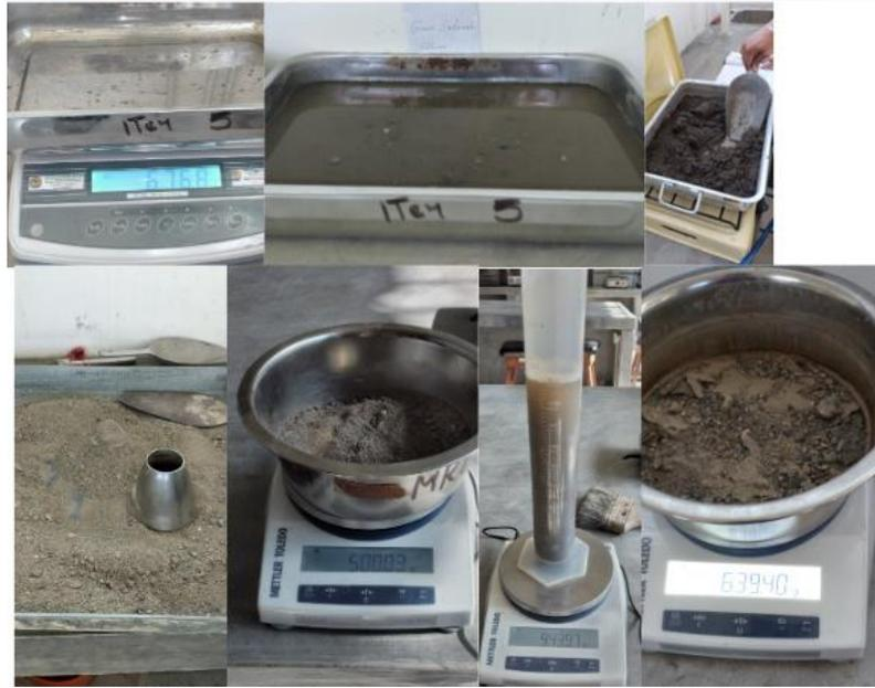
*Figura 45. Aplicación de la Norma ASTM C-127.*
