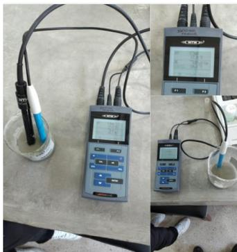
*Figura 19. Ensayo de conductividad, salinidad y pH.*
