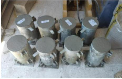
*Figura 21. Probeta de hormigón*
