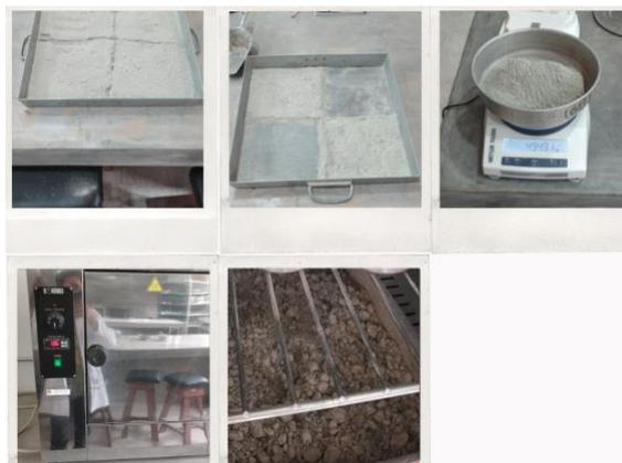
*Figura 35. Ensayo del contenido de humedad del relave minero*
