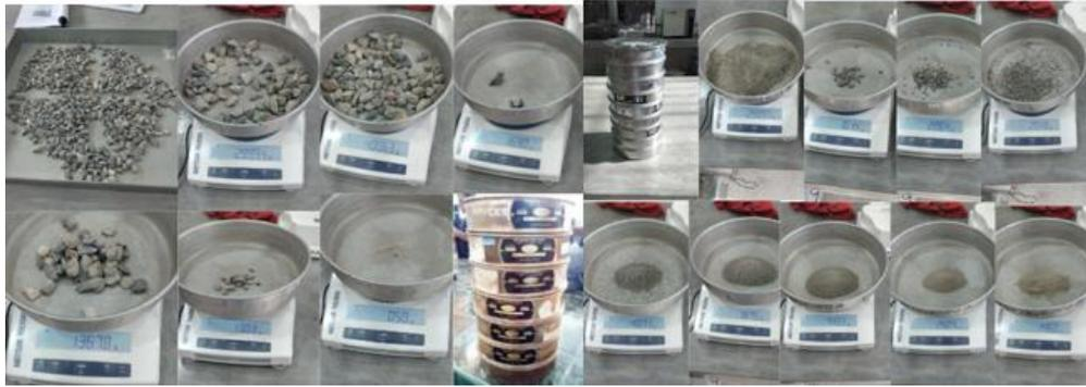
**Figura 42.** Análisis granulométrico de los agregados fino y grueso.
