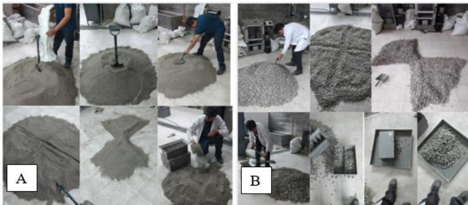
**Figura 40.** A) Cuarteo del agregado fino; B) Cuarteo del agregado grueso.
