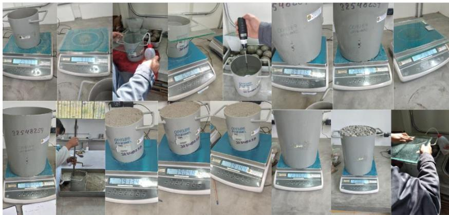
**Figura 43.** Aplicación de la Norma ASTM C-29, de los agregados componentes del hormigón patrón.
