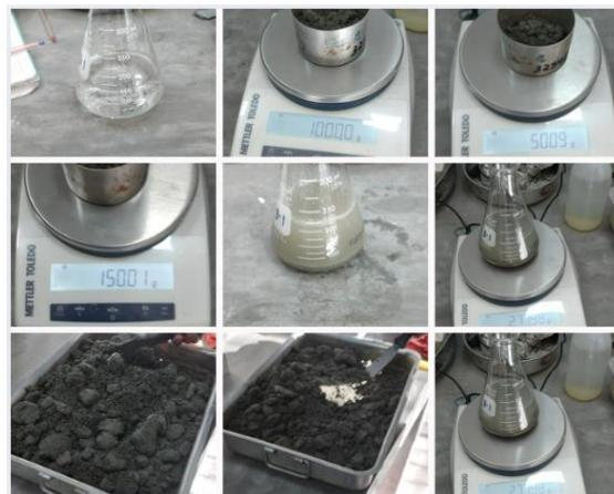
*Figura 37. Ensayo de densidad real del relave minero.*
