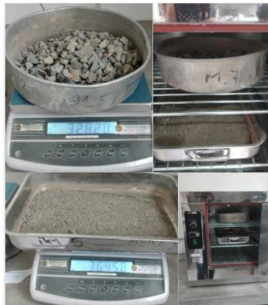
**Figura 41.** Contenido de humedad de los agregados.
