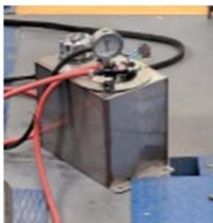
**Figura 8** Tanque externo de combustible
