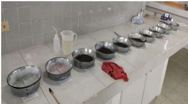
**Anexo 6.** Extracción y colocación de nematodos fitoparásitos en portaobjetos para su debida identificación.
