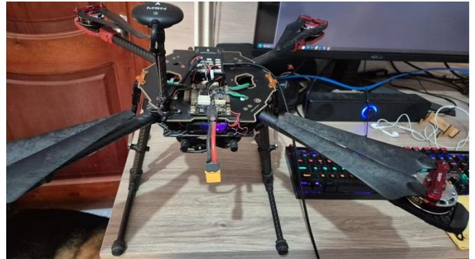
Una vez se presione en “Clic when Done”, una nueva posición deberá ser cumplida, en este caso hay que posicionar el UAV hacia la izquierda, siempre manteniendo la dirección de la controladora de vuelo hacia delante, ese será el punto de referencia. Se hizo uso de una superficie de apoyo para mayor precisión.
