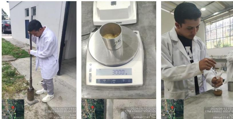
**Figura 13.** Ensayo peso específico real.
