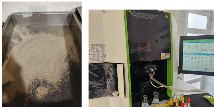
**Figura 15.** Ensayo Espectrofotometría de absorción atómica.
