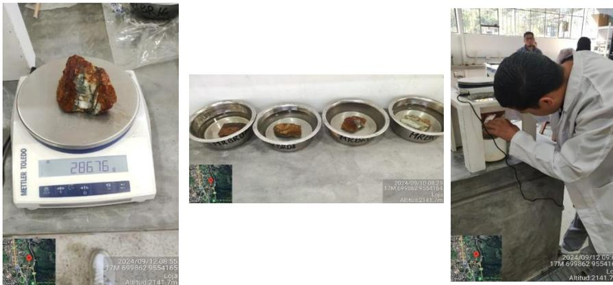
**Figura 12.** Ensayo peso específico aparente.
