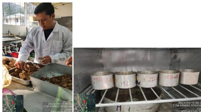
**Figura 11.** Ensayo contenido de humedad.
