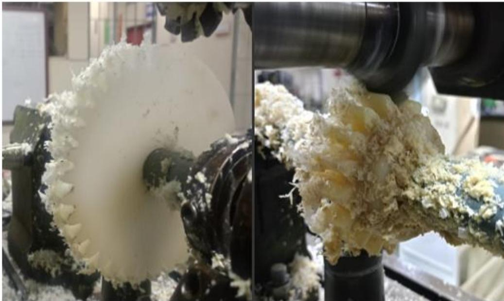
**Figura 31.** Fresado de engranajes.
