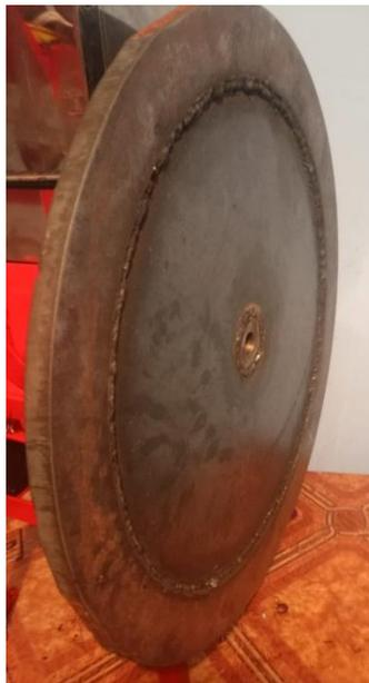
**Figura 33.** Volante de inercia
