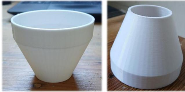
**Figura 18.** Cono de obstrucción del paso de aire impreso en 3D.
