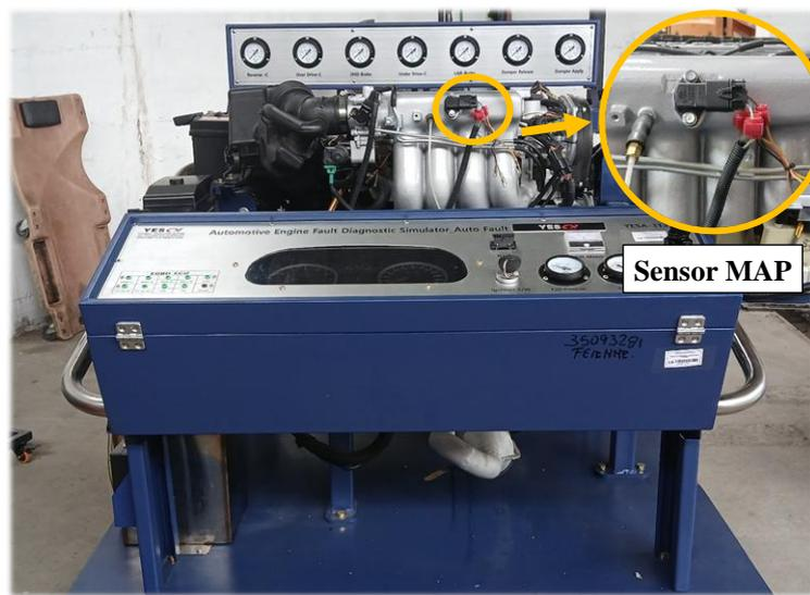
**Figura 17.** Ubicación del sensor MAP en la Unidad Experimental YESA 3133.
