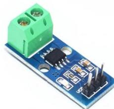
**Figura 8.** *Sensor de corriente.*
