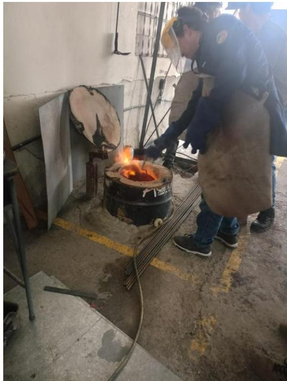
**Figura 55.** *Proceso de fundición del plomo.*
