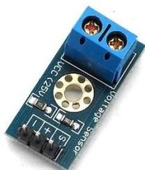
**Figura 9.** Sensor de voltaje.
