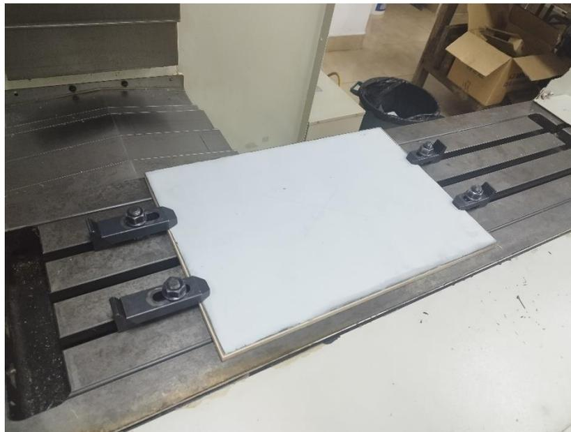
**Figura 38:** Montaje de la plancha en la mesa de la CNC
