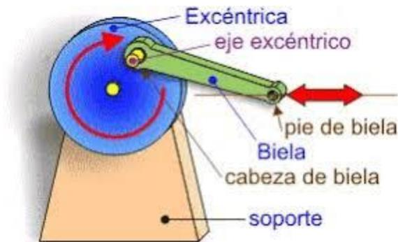
**Figura 21:** Esquema del mecanismo biela-manivela corredera.
