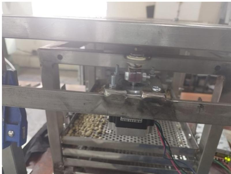
**Figura 47:** Sistema de vibración
