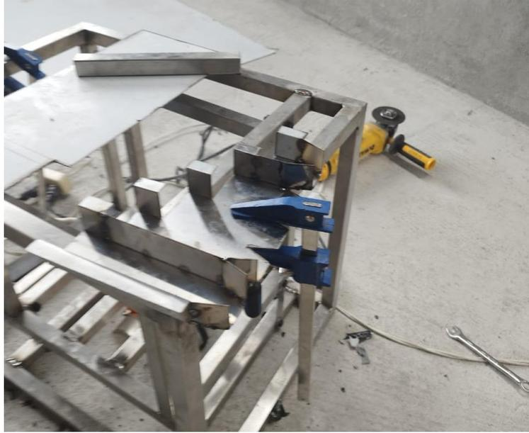
**Figura 45:** Soldado de los separadores en la tolva de salida
