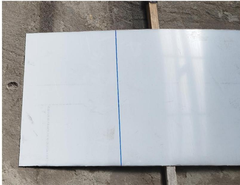
**Figura 36:** Trasado y corte para perforación de las mallas
