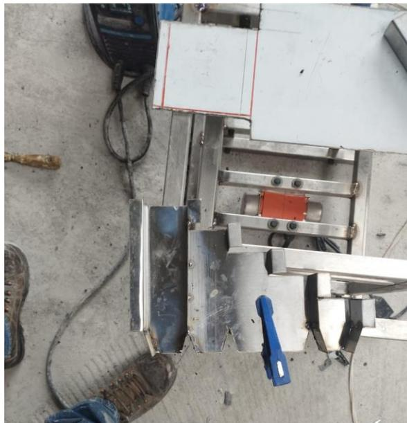
**Figura 44:** Corte y armado de tolva de salida
