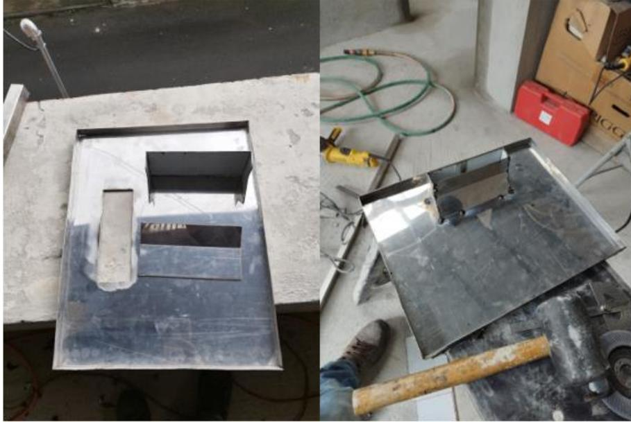
**Figura 43:** Acople de la tolva en la tapa superior por soldadura
