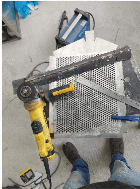
**Figura 40:** Trazado y corte de las zarandas
