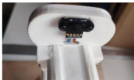
**Figura 31.** Colocación del sensor en su debida base.
