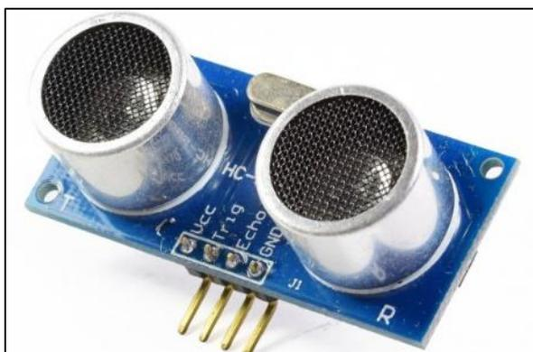
**Figura 11.** Sensor de proximidad ultrasónico.
