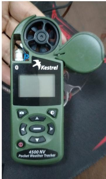
**Figura 56.** Anemómetro Kestrel 4500NV Electronic Hand Held Weather Meter
