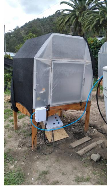
(b) Prototipo automatizado cubierto con polisombra al 80 %
