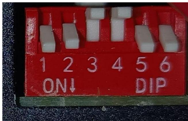
**Figura 64.** Configuración switches TB6600.
