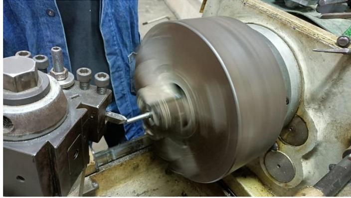
**Figura 65.** Cilindrado hasta el diámetro del rodamiento para el tornillo de potencia.
