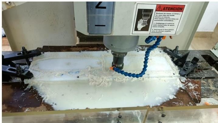
**Figura 66.** Mecanizado de piezas en fresadora CNC.
