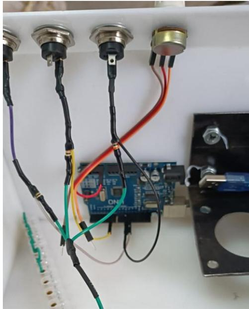
**Figura 71.** Instalación del cableado para el sistema de control.
