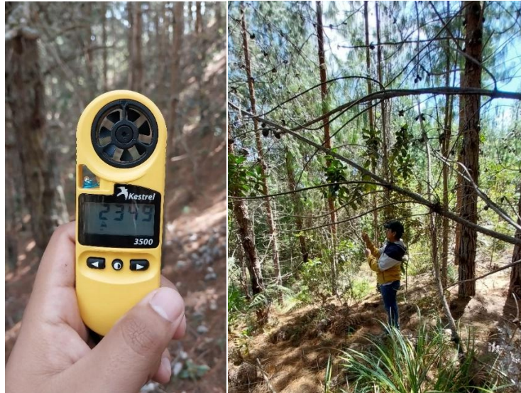
Figura 5. Medición de las variables ambientales con la estación micro climática Kestrel 3 500 en una plantación de Pinus patula .
