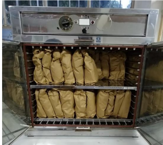
Figura 4. Secado del material vegetal en estufa a 55 °C/ 24 hrs
