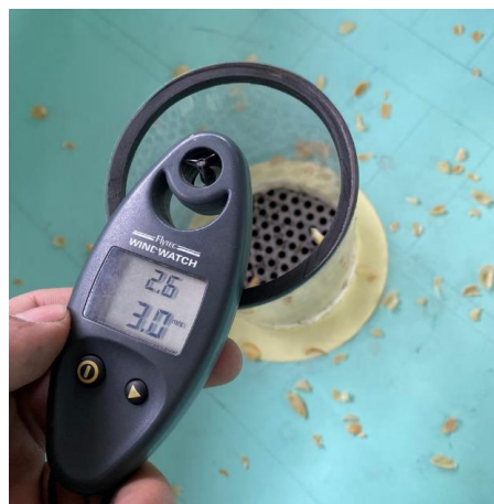
Figura 53. Medición de la velocidad de aire crítica para la expulsión del cisco en el ducto circular.
