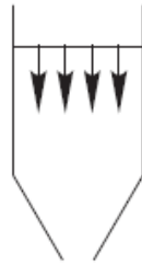
Figura 76. Flujos en la tolva Fuente: (Zuriguél Ballaz, 2005)
