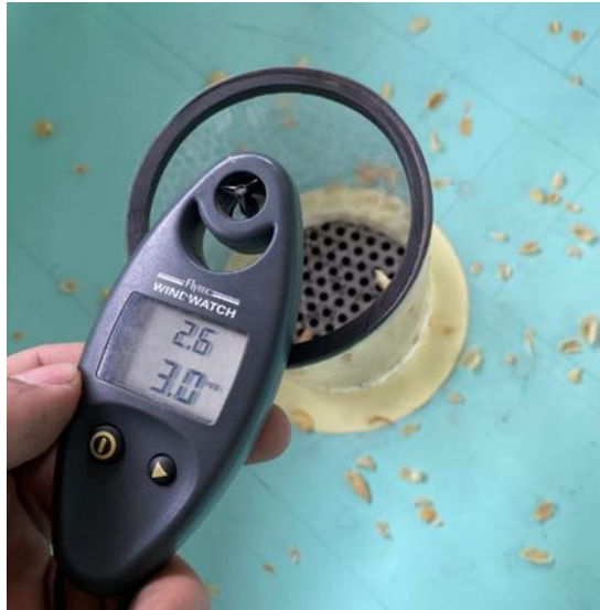
Figura 108. Medición de la velocidad de aire crítica para la expulsión del cisco en el ducto circular Fuente: (Autor)
