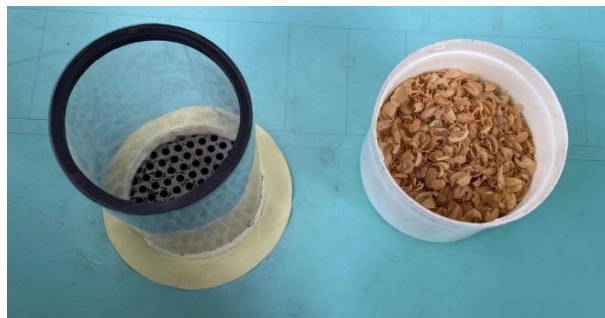
Figura 107. Ducto experimental con base perforada y cisco de café para evaluación de velocidad de transporte
