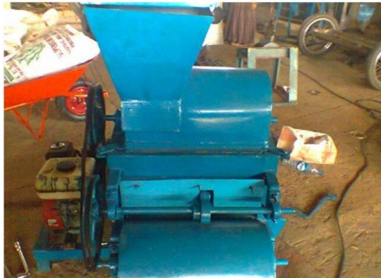
Figura 140; Máquina trilladora de café resultado de la investigación y diseño mecánico.
