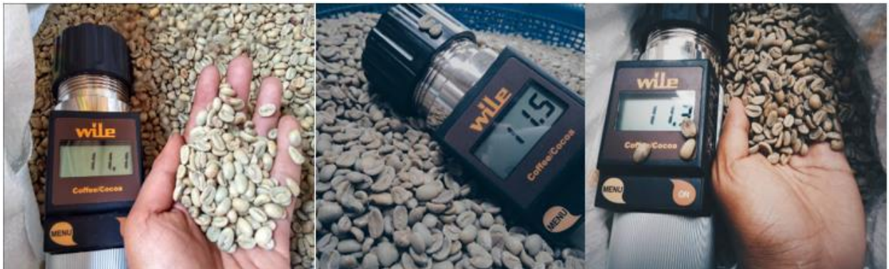
Figura 3. Medición de humedad de grano de café pergamino. Fuente: Floresien Coffée en Instagram [Captura de pantalla].
