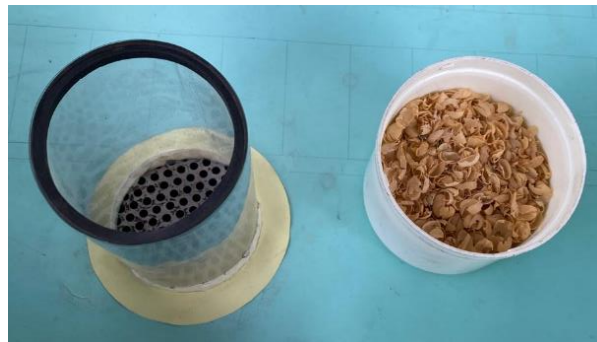
Figura 52. Ducto experimental con base perforada y cisco de café para evaluación de velocidad de transporte.
