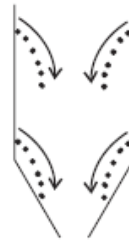
Figura 76. Flujos en la tolva Fuente: (Zuriguél Ballaz, 2005)
