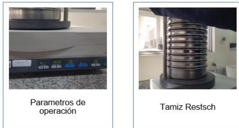
**5.5.1.2. Densidad:** Para el análisis de densidad se analiza una muestra representativa, que fue secada, y se tamiza con malla #200, es importante determinar la densidad específica.
