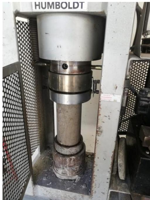
**Figura 12:** Ensayo de resistencia a la compresión para el concreto original.
