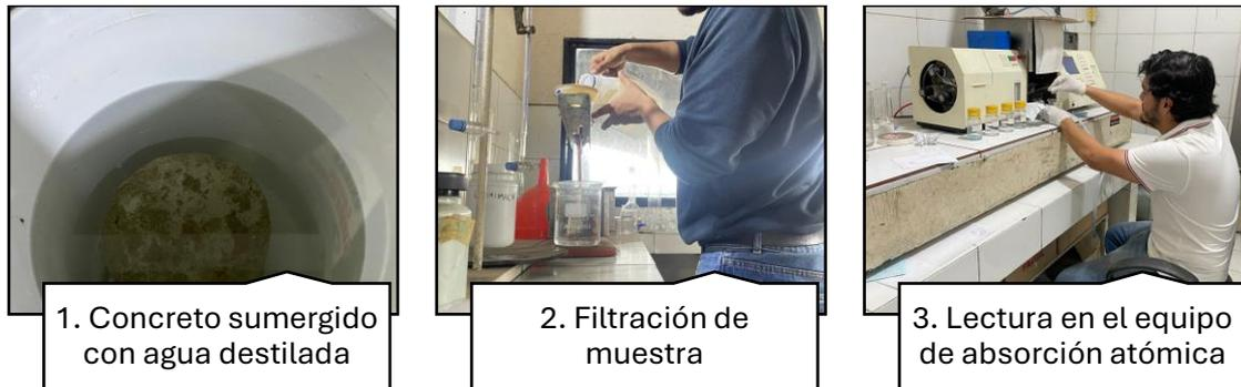
**Figura 11:** Preparación de muestra para el lavado de la probeta del concreto con el 20% de relave.
