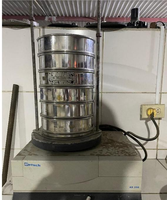
**Figura 8:** Agitador mecánico de tamices laboratorio químico Cormirey-Pambil, 2024
