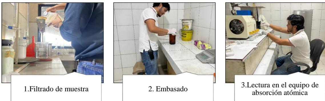
**Figura 10:** Preparación de muestra del lavado del relave para detección de metales pesados.
