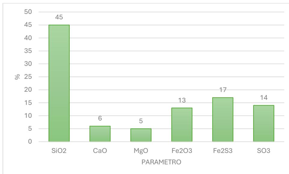
**Figura 15:** Concentración porcentual determinados por fluorescencia de rayos x.
