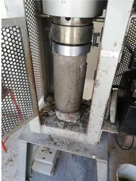
**Figura 13:** Ensayo de resistencia a la compresión para el concreto con 20% de relave
