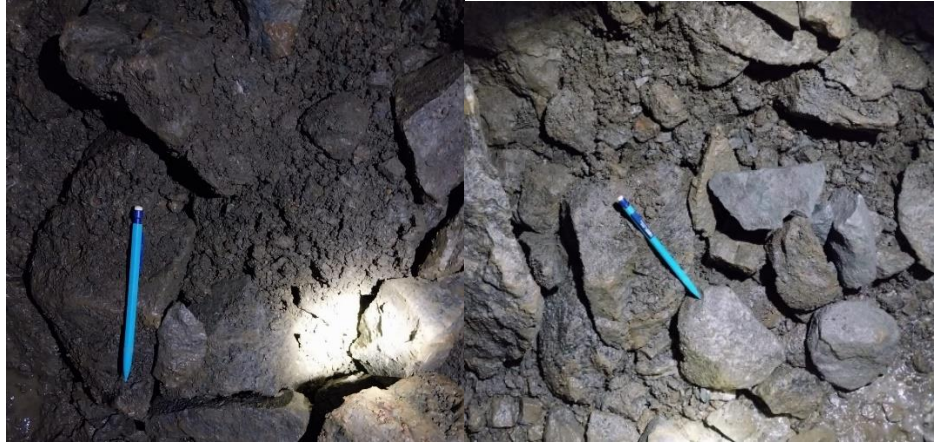
Figura 15. Roca desprendida de la voladura.
