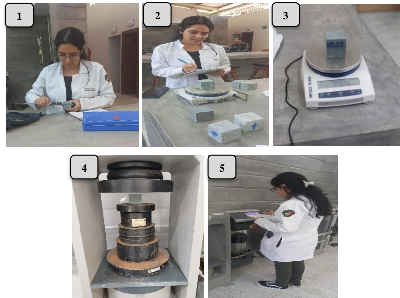
Figura 11. Proceso para realizar el ensayo de compresión
