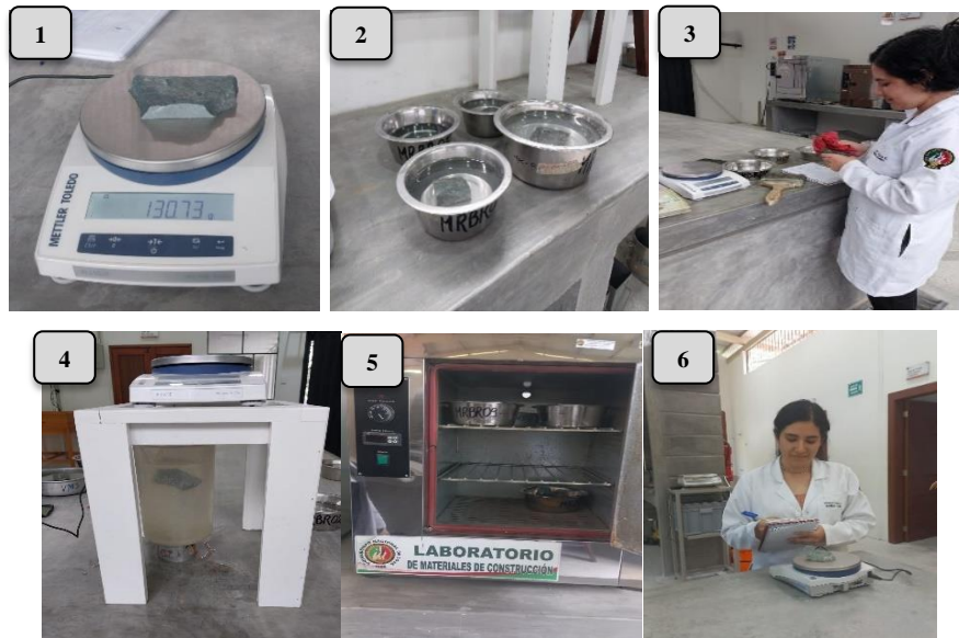
Figura 9. Proceso para determinar el peso específico aparente
