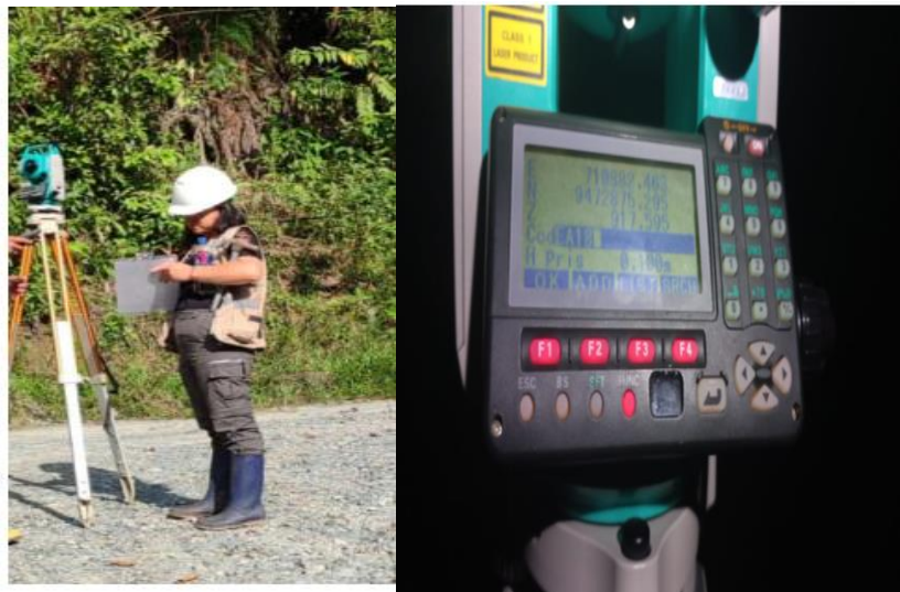
Figura 7: Levantamiento topográfico con estación total.
