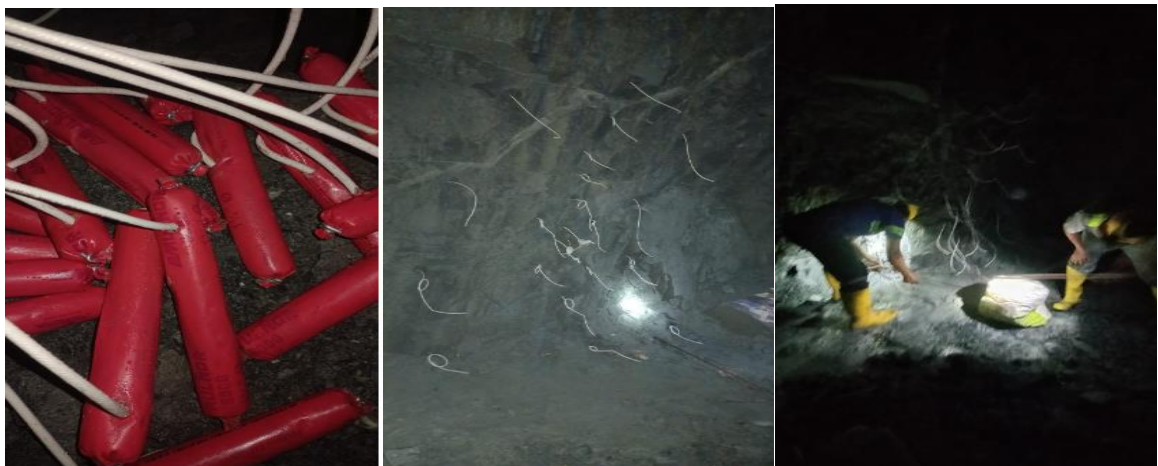
Figura 13: Retacado de la sustancia explosiva.
