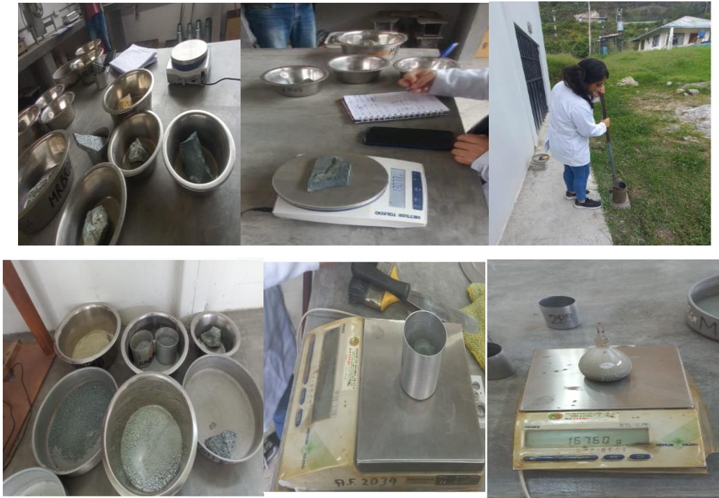
Figura 10: Ensayo del peso específico real.
