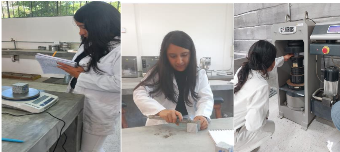
Figura 11: Ensayo de compresión simple
