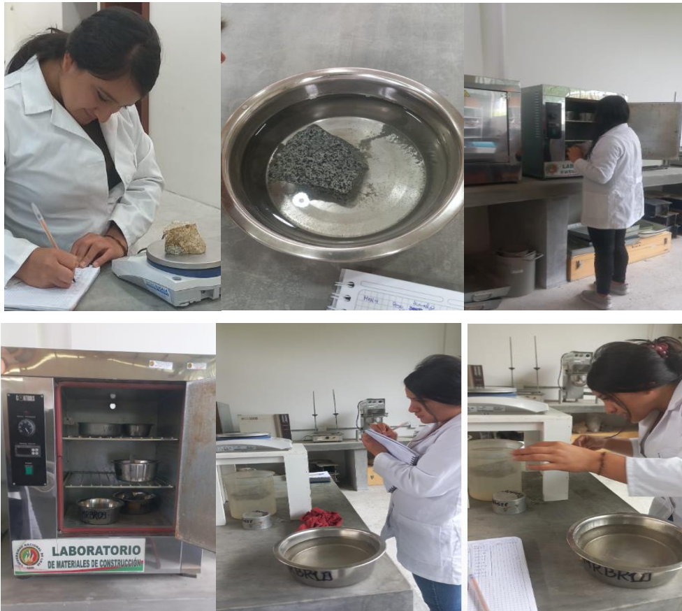
Figura 9: Ensayo del peso específico aparente
