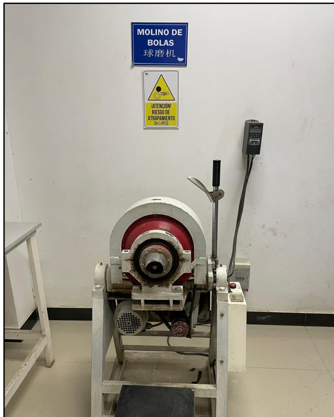
Anexo #6. Molino de bolas escala laboratorio
