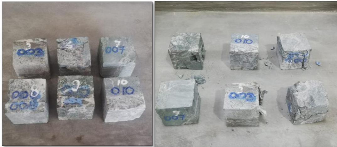
Figura 50: Ensayo de RCS (Antes y después)
