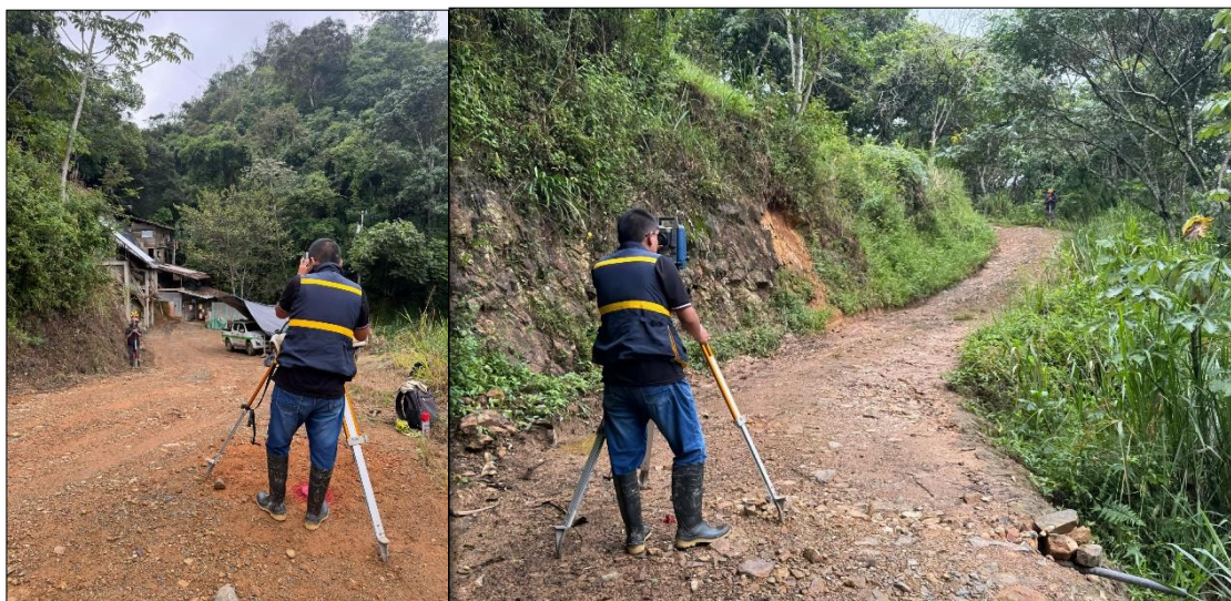
Figura 16: Levantamiento topográfico (fecha de captura: 2024/04/02)
