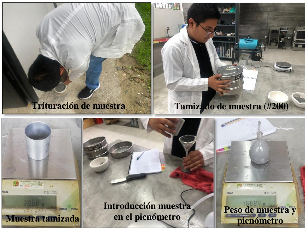
Figura 29. Procedimiento para determinar el peso específico real
