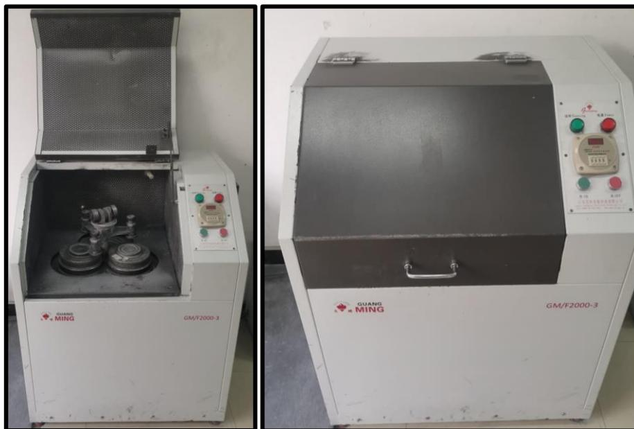
Figura 21. Pulverizadora de tres cabezas
