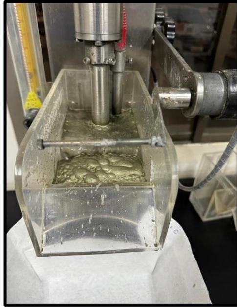
**Figura 12.** Espuma de concentrado de Cobre
