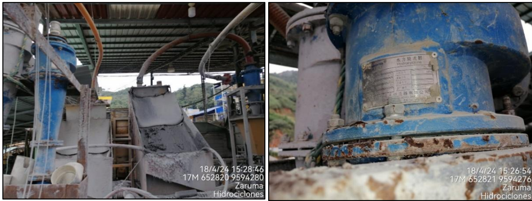
Figura 27. Hidrociclón para reclasificación de tamaños
