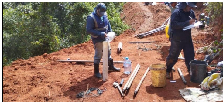
Figura 10. Ensayo de permeabilidad
