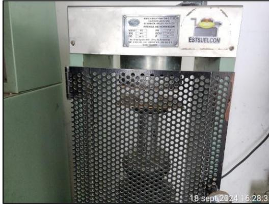
**Figura 19.** Resistencia a la compresión simple.
