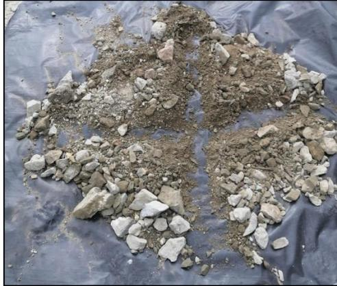
**Figura 18.** Muestra en fracciones (Cuarteo).
