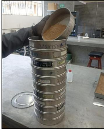
**Figura 24.** Muestra clasificada a malla #200.
