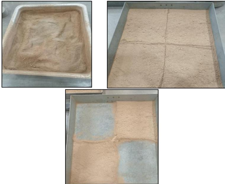
**Figura 21.** Muestra homogeneizada y cuarteada.
