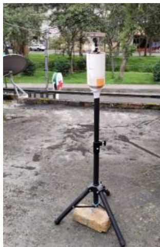
Anexo 7. Trípode usado para la recolección de muestras del agua de lluvia
