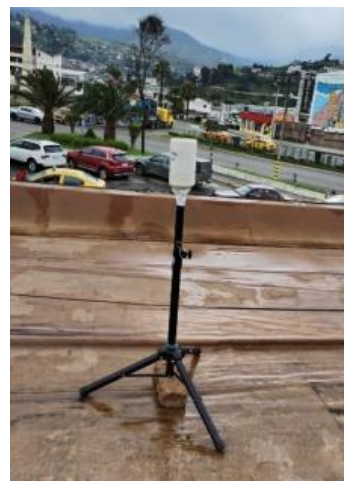
Anexo 7. Trípode usado para la recolección de muestras del agua de lluvia
