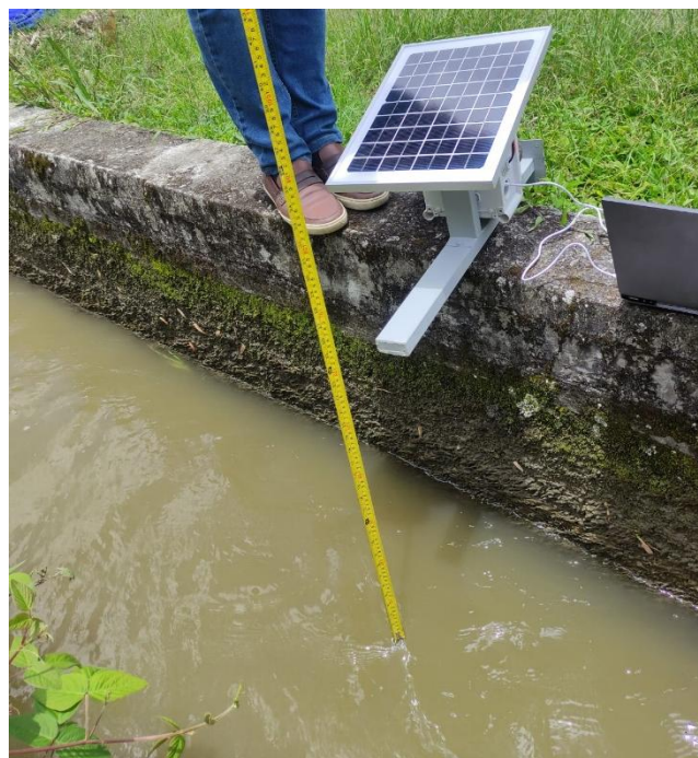
Figura 62. Comprobaciones del nivel de agua
