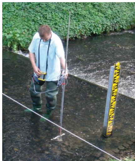
Figura 5. Uso de molinete de barra OTT C31
