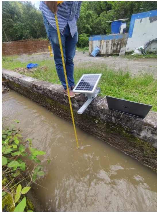
Figura 86. Comprobación de dimensiones del canal
