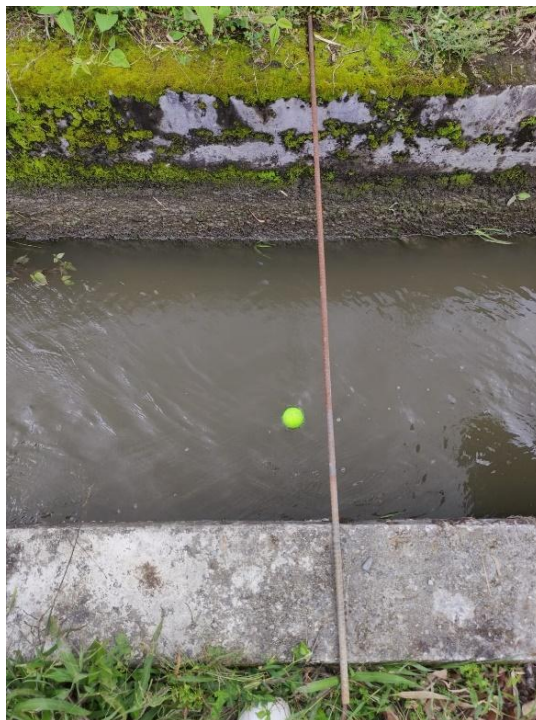
Figura 58. Medición del tiempo de recorrido de la pelota
