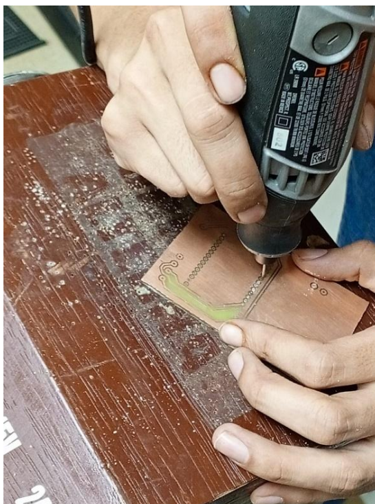
Figura 83. Construcción de placa electrónica
