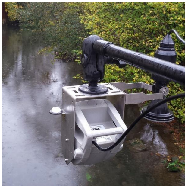
Figura 6. Medidor de caudal Phoenix
