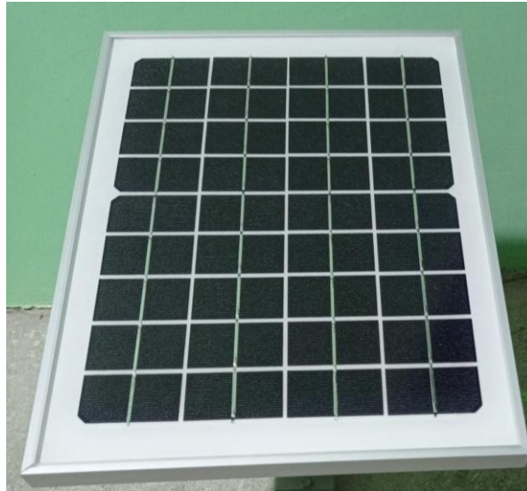
Figura 37. Panel fotovoltaico monocristalino
