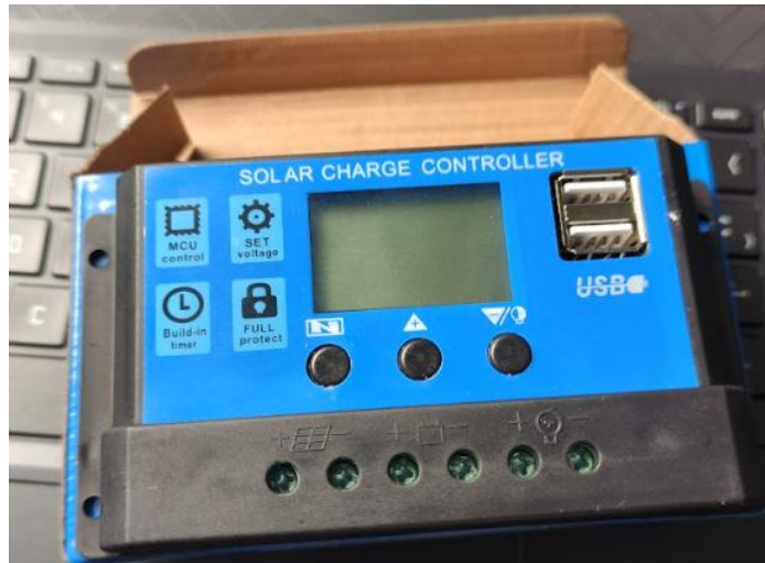
Figura 39. Controlador solar de 12/24 V de 10 A
