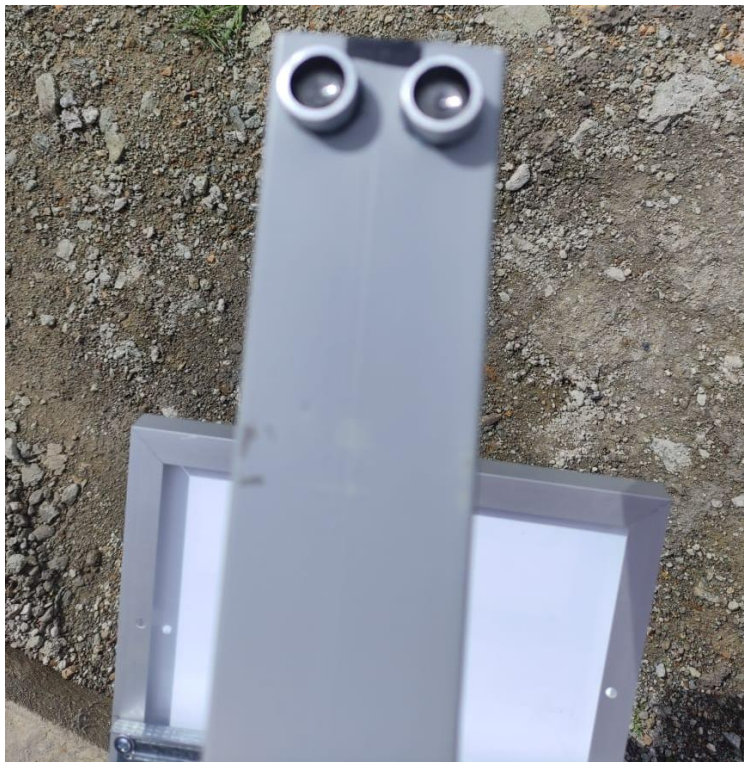
Figura 81. Colocación del sensor ultrasónico
