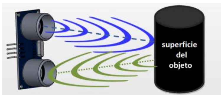
Figura 20. Funcionamiento del sensor ultrasónico
