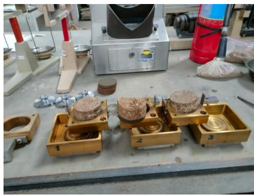
Figura 30 Porciones de suelo de las pastillas en el ensayo de corte directo
