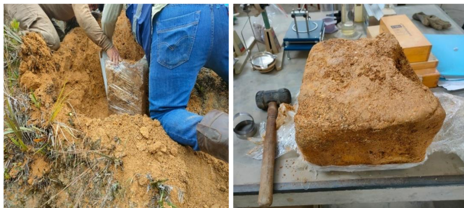
Figura 29 Cubo de suelo extraído en campo para los ensayos de corte directo
