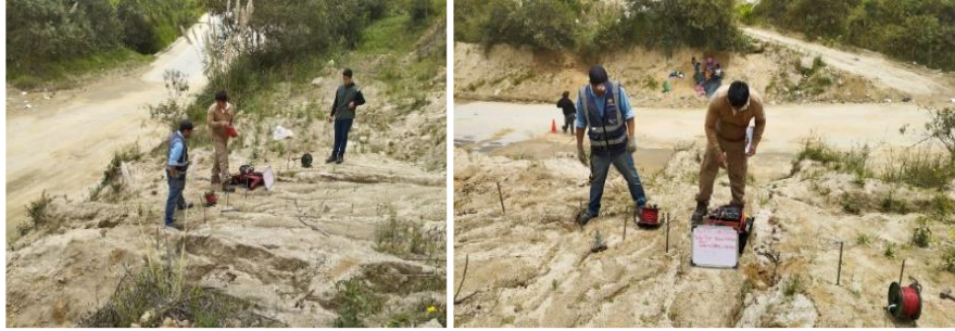
Figura 33. Equipo utilizado y ejecución del tendido del SEV
