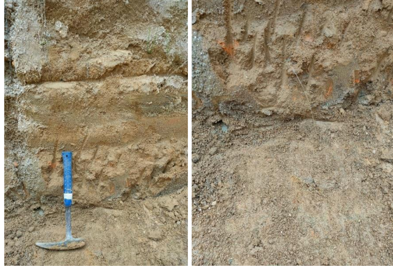
Figura 26 Apertura de calicata a 1 m de profundidad
