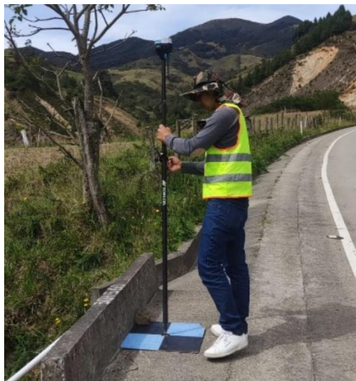
Figura 18 Toma de puntos de control y establecimiento de marcas
